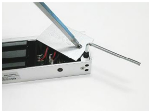
1. เปิดน็อตช่องวงจรและใช้ 6 เหลี่ยมหมุน 2 แกน
