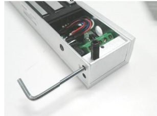
6. ยึดน็อตเข้ากับตัว L แล้วหมุนน็อต 6 เหลี่ยมล็อค
