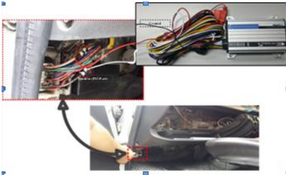
รูปที่ 5. การต่อสาย I/O Cable เข้ากับระบบไฟรถ
