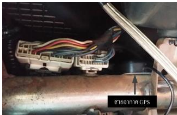
รูปที่ 9. การติดตั้งสายอากาศ GPS
