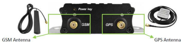
รูปที่ 8. การต่อสาย Antenna
